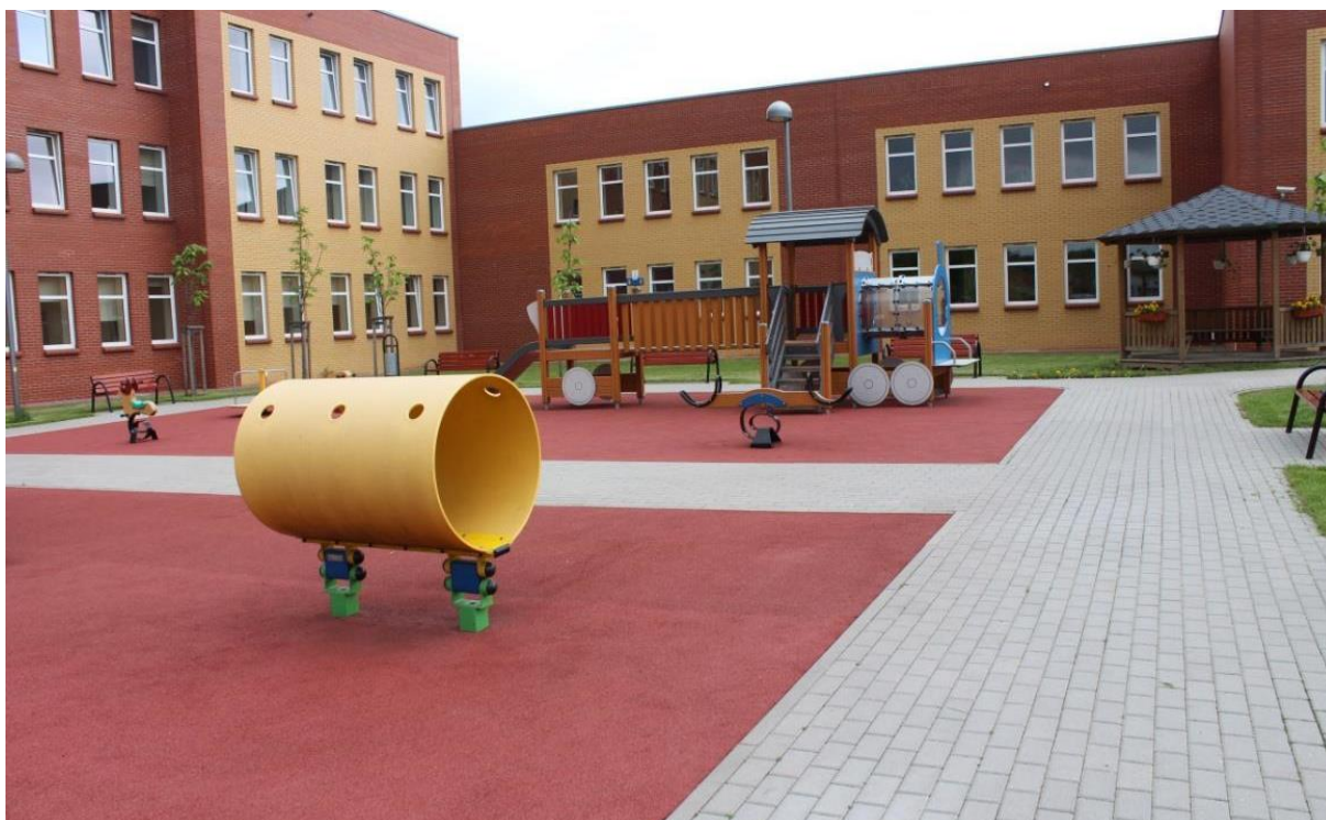
Rysunek 61. Przykład rozdzielania strefy komunikacyjnej od rekreacyjnej za pomocą stosowania nawierzchni o różnym zabarwieniu i strukturze [fot.: N. Ratajczak-Szponik].
