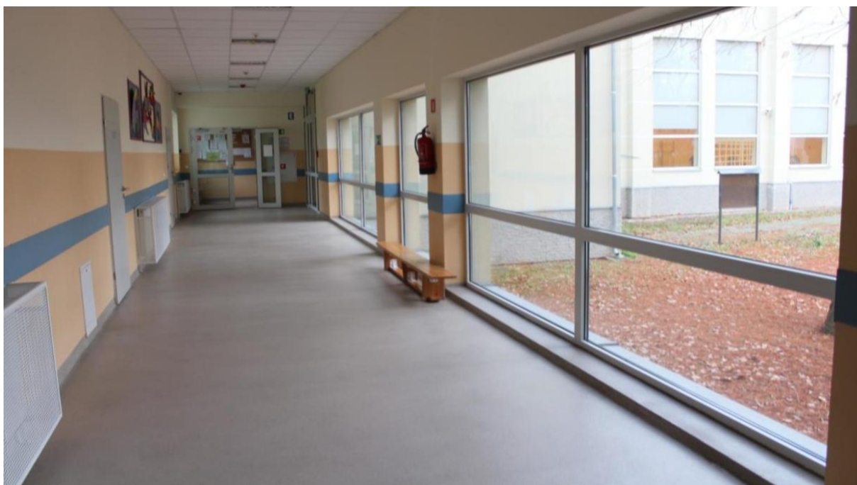
Rysunek 20. Przykład oświetlenia korytarza światłem naturalnym z okien usytuowanych wzdłuż ściany [fot. N. Ratajczak-Szponik].
